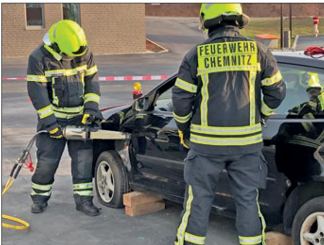
Technische Rettung aus PKW – Entfernen der Fahrzeurtür, Zersägen der Frontscheibe
